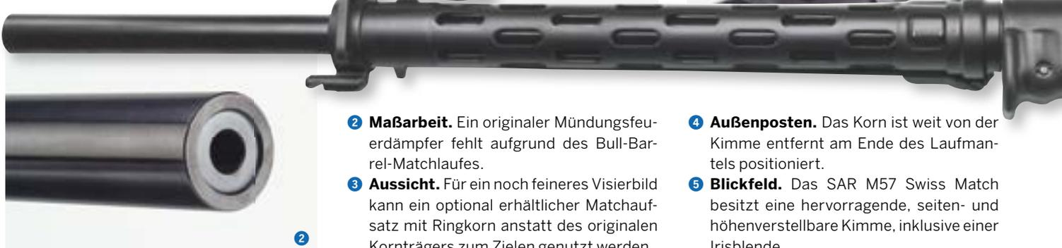
**2 Maßarbeit.** Ein originaler Mündungsfeuerdämpfer fehlt aufgrund des Bull-Barrel-Matchlaufes.
